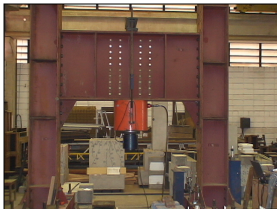
c) Pórtico metálico, capacidade de 5000 kN.
