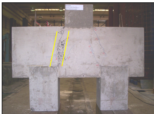
Figura 6.3 – Plano de ruptura ao longo da altura do bloco, modelo B45P25E25A sw,C , vista de frente.
