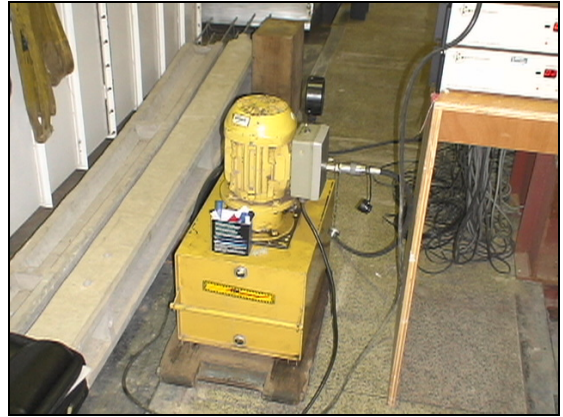
b) Bomba elétrica de carga e descarga.
