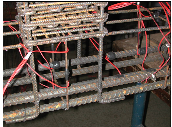
Figura 5.17 – Detalhes dos extensômetros instalados no estribo vertical, modelo B35P25E25e0.
