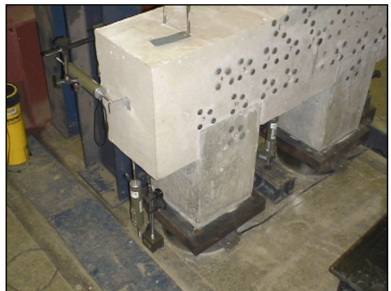
g) Transdutores de deslocamento.
