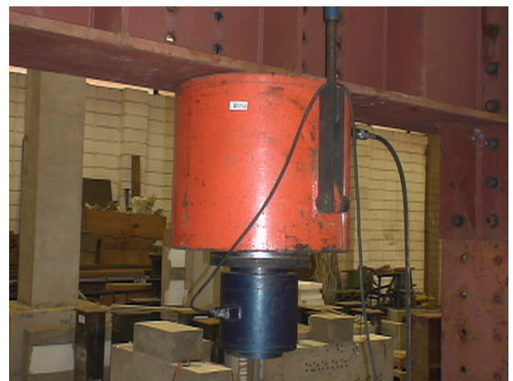
d) Pistão hidráulico e célula de carga, capacidade 5000 kN.
