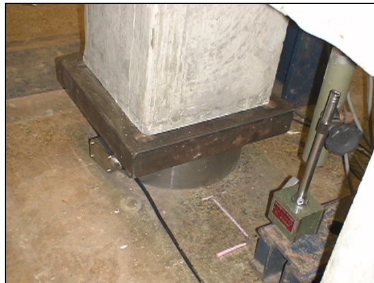
Figura 5.3 – Placa de aço sobre à célula de carga com capacidade igual a 2000 kN.
